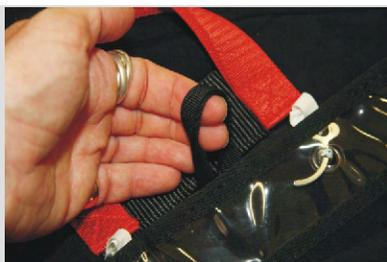
**Finaler Check:** Die Verbindungsleine zwischen Griff und Innencontainer muß **lang genug** sein, um das **Lösen der Splinte zu ermöglichen**.
