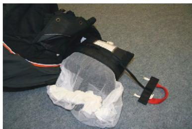
2. Schlaufen **müssen nach oben** (zum Sitzbrett) zeigen. Der Auslösebeschleuniger (weißer Schirm) wird in Flugrichtung **nach hinten** gelegt.
