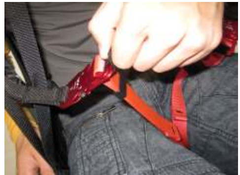
Abb. 19: Verlängern einer Beinschlaufe
