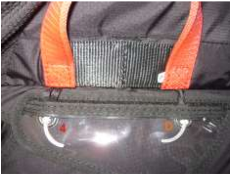
Abb. 11: Vordere Verschlusslasche mit Splinten gesichert, Auslösegriff verstaut
