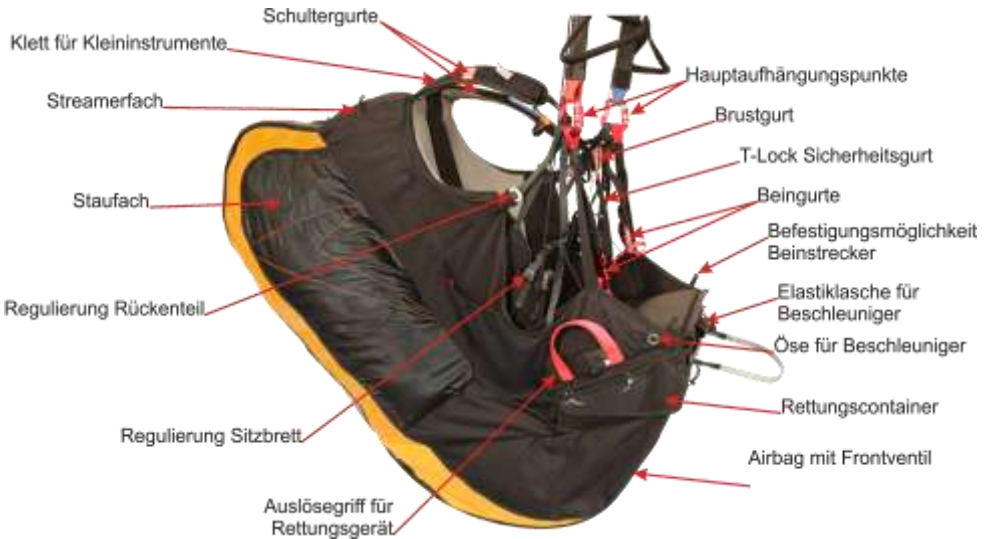
Abb. 1: Übersichtszeichnung des Connect Reverse Evo
