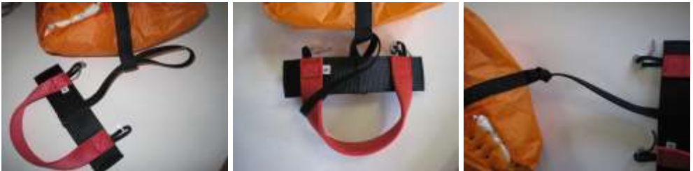
Abb. 6: Einschlaufen des Auslösegriffs
