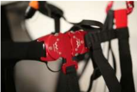
Abb. 2: Brustgurt mit geschlossenem T-Lock
