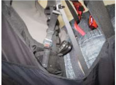
Abb. 15: Schnalle zur Einstellung der Sitzbrett- neigung (Bildmitte)
