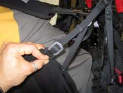
Abb. 13: Schnalle zur Einstellung der Rücken- neigung
